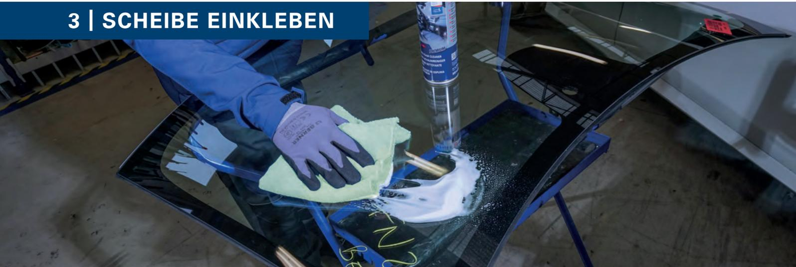
Bevor die neue Windschutzscheibe eingeklebt wird, muss sie gereinigt und die Grundierung aufgebracht werden. Berner bietet hochmodulare Windschutzscheibenklebstoffe für kürzere Wegfahrzeiten und schnellere Reparaturen.
