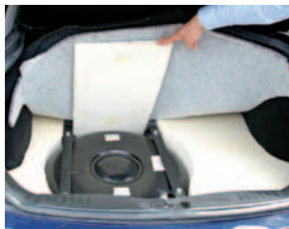
Maximaler Radmuldentank | Der Kofferraumboden wurde mit Schaumstoffblöcken angehoben
