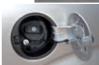
Wirtschaftliches Trio: Unter der Tankklappe (links) befindet sich auch der Befüllstutzen für den Gastank.
