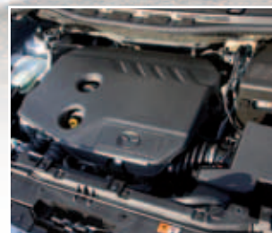
Der 115 PS leistende 1,6-Liter-Diesel ist leicht, kultiviert, sparsam und durchzugsstark.
