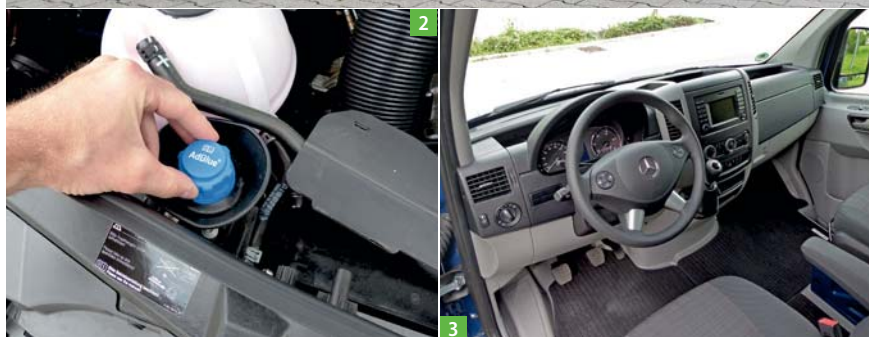
1 | Seit 2013 gibt es die aktuelle Sprinter-Generation 2 | Adblue wird hier noch umständlich im Motorraum nachgefüllt, nicht seitlich 3 | Top verarbeitetes Cockpit, aber etwas fummeliges Handling
