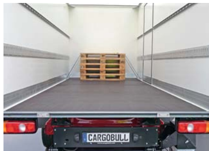
Ladungssicherung | Seitliche Airline-Schienen sind beim Kofferaufbau serienmäßig dabei
