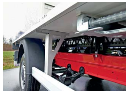
Hoch hinaus | Der Koffer selbst wirkt luftig, aber stabilisiert wird er mit einem großen Hilfsrahmen
