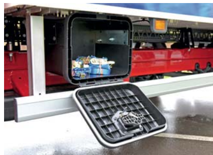
Aufbewahrung | Am Rahmen bleibt Platz für ein Staufach, in das die Zurrgurte gut hineinpassen
