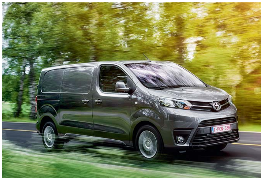
Kompakter Lieferwagen | Auf 4,60 bis 5,30 Meter Länge können 1,0 und 1,4 Tonnen geladen werden
