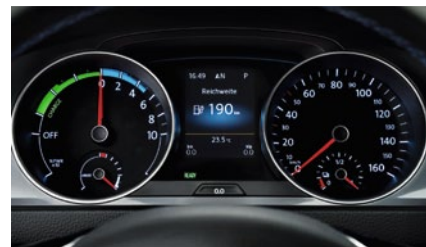
Reichweite | Statt des Drehzahlmessers rückt die wichtige Anzeige des Ladezustandes ins Blickfeld
