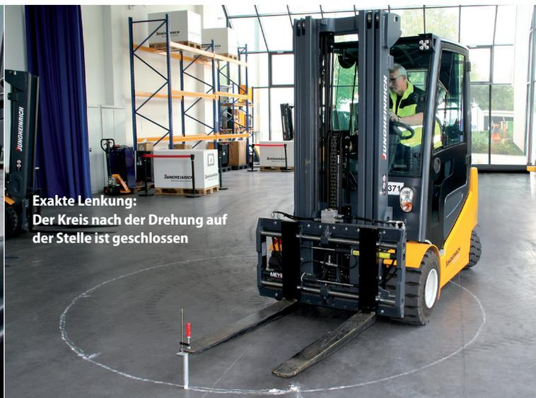
Exakte Lenkung: Der Kreis nach der Drehung auf der Stelle ist geschlossen
