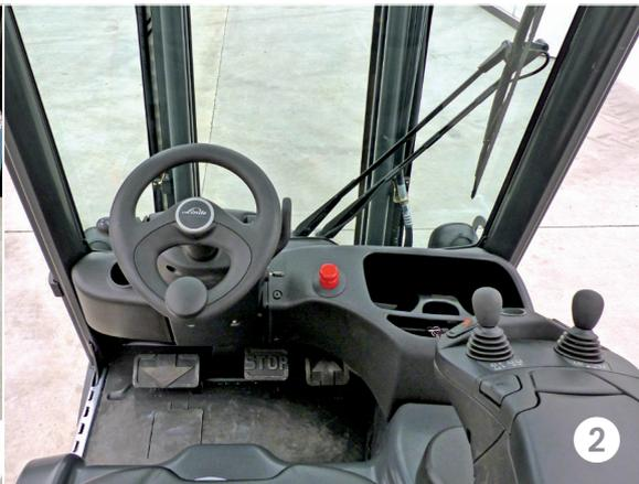
1 Zum Batteriewechsel reicht ein Handhubwagen. 2 Unter dem Lenkrad zu sehen: Die Doppelpedalerie zum Vorwärts- und Rückwärtsfahren. 3 In der Armlehne lässt sich wertvoller Kleinkram verstauen. 4 Die Box für das Onboard-Ladekabel ist eng und hakelig. 5 Zum Einsteigen ist der Griff gut positioniert, zum Aussteigen nicht. Die Stufe ist hoch. 6 Beim Anfahren an der Rampe rollt der Stapler nicht zurück
