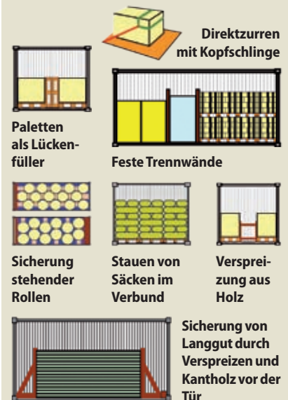
Beim Transport auf der Schiene gelten andere Beschleunigungsbeiwerte als auf der Straße. Dieser Umstand ist beim Verladen zu beachten.
