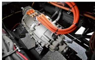
Der ZF CeTrax-Antrieb, hier verbaut in einem Versuchsbus, gezeigt in Kortrijk
