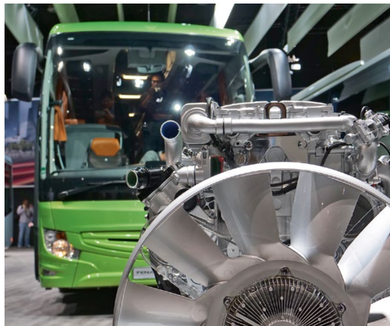
Heute ist das Ziel von Nutzfahrzeugherstellern, den Dieselmotor weiter zu optimieren. Hier zu sehen der neue OM 936, auch im Reisebus verbaut
