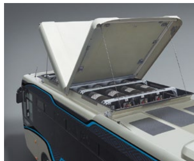
Die Gasbehälter beim neuen Crossway NP befinden sich geschützt auf dem Dach
