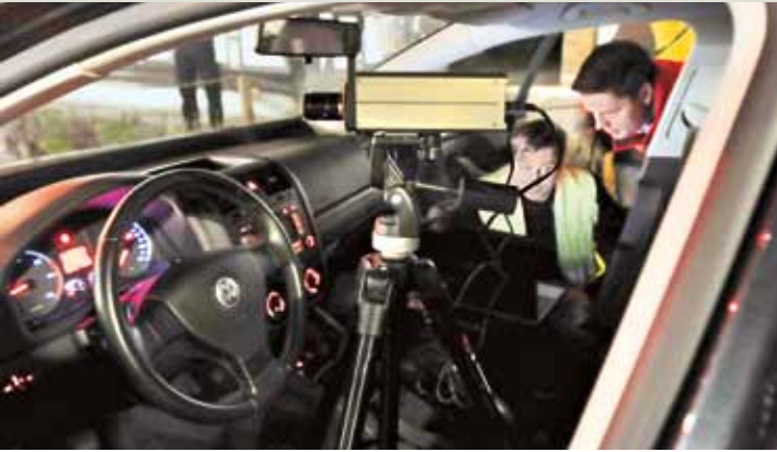
Die Leuchtdichte-Messkamera wird in Augenhöhe des Unfallfahrers postiert.
