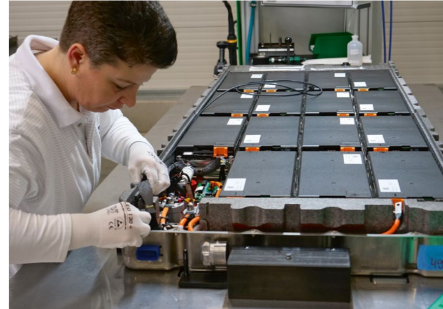
Einbau der Schützbox in ein Evobus-Batteriesystem. In diesem Fall befindet sich die Schützbox im Trog. Es gibt aber auch andere Systeme, in denen diese Batterie-Fahrzeug-Schnittstellen außen liegen
