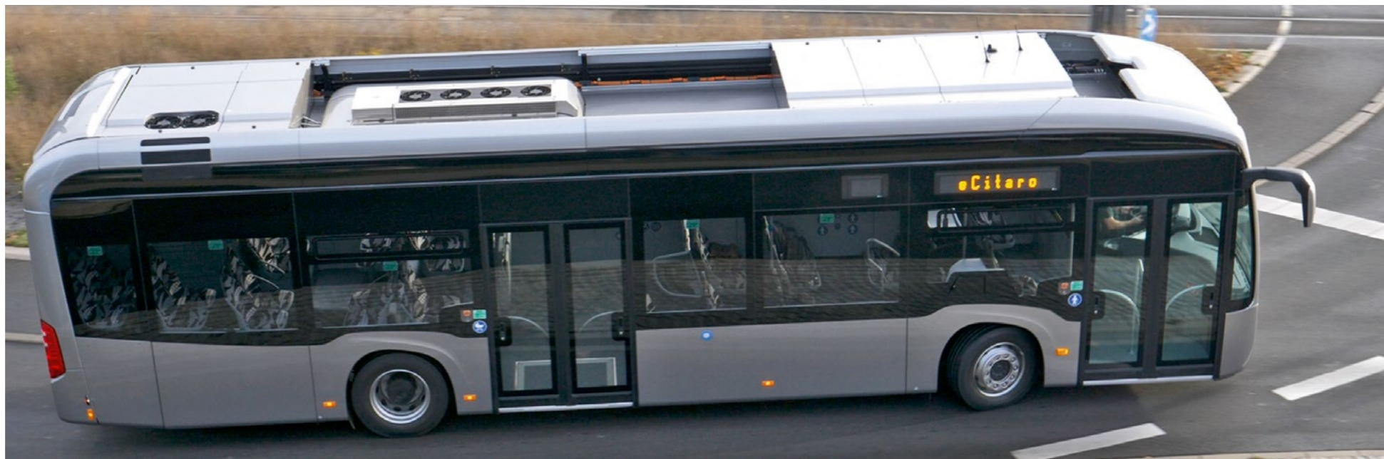
Die drei Fotos hier zeigen die Einbauorte der Akasol-Batteriesysteme beim eCitaro. Sie befinden sich standardmäßig im Heck und bei Bedarf auf dem Dach im vorderen Bereich. Gut zu erkennen ist die Anbindung des Kühlsystems
