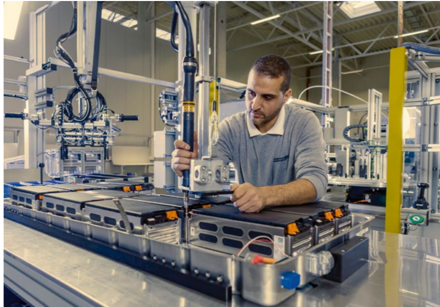
Das Bestücken des Systems erfolgt nach dem Auflegen des Batterie-Managementsystems halbauto-matisch. Die Verschraubung wird für jede einzelne Schraube elektronisch dokumentiert
