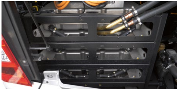
Die drei Fotos hier zeigen die Einbauorte der Akasol-Batteriesysteme beim eCitaro. Sie befinden sich standardmäßig im Heck und bei Bedarf auf dem Dach im vorderen Bereich. Gut zu erkennen ist die Anbindung des Kühlsystems
