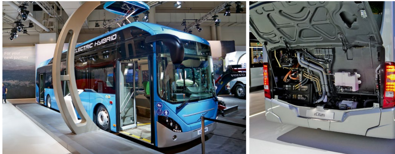
Volvo setzt auf die offene Ladeschnittstelle OppCharge. Vereinheitlichung ist wichtig
