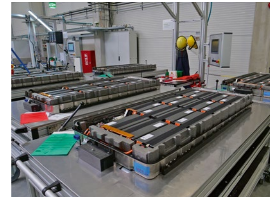
In diesem Zustand ist das Batteriesystem noch nicht im Hochvolt-Zustand, also sicher
