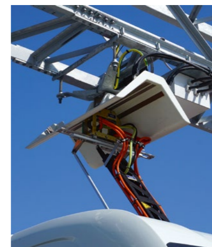
Stecker (o.) oder Pantograf: Das Laden eines Elektrobusses folgt dem Einsatzplan und ist im Depot oder auf der Strecke möglich
