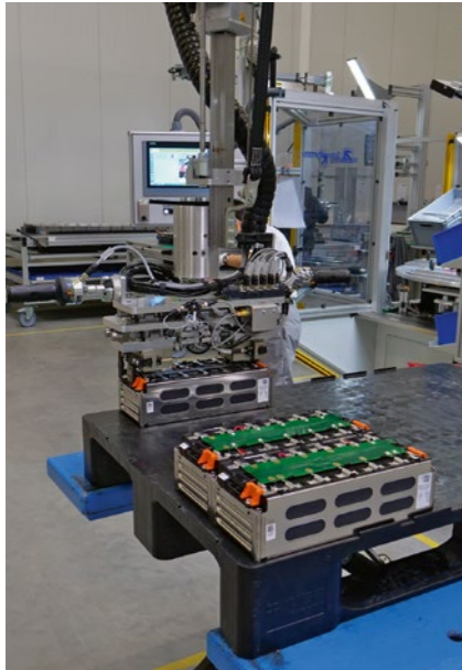
Die Evobus-Module werden zugeliefert, normalerweise werden nur die Zellen bezogen
