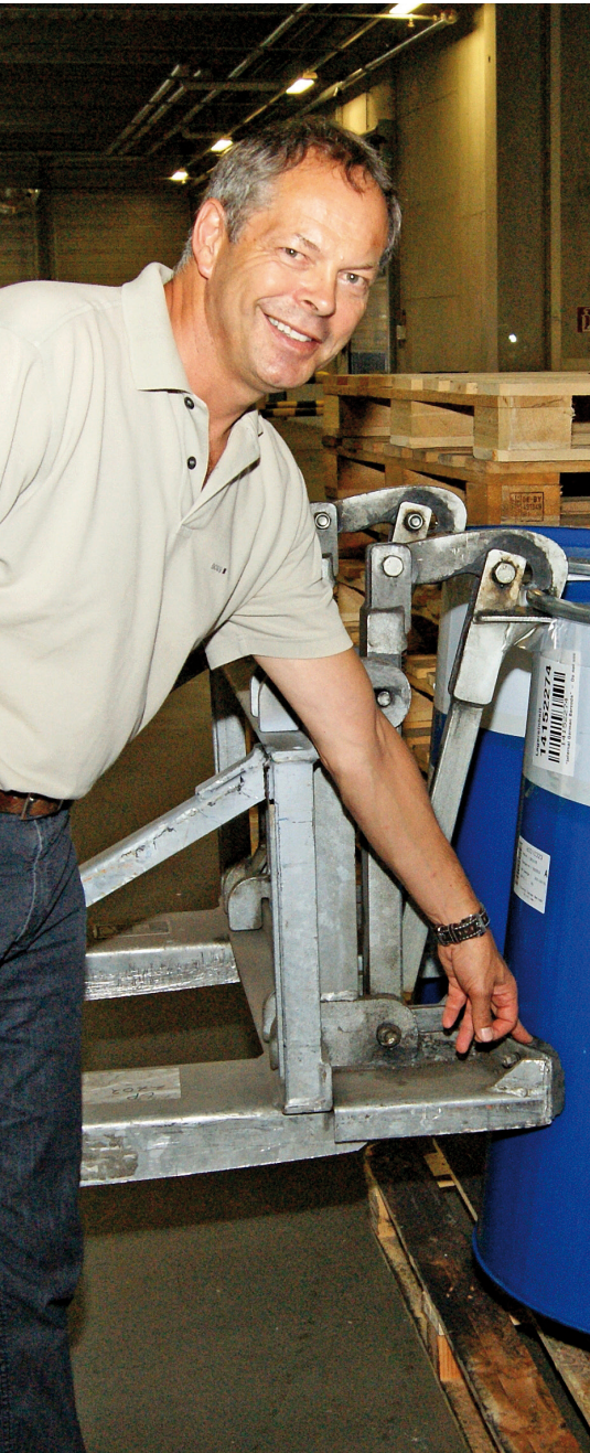
Wolfgang Huber zeigt auf die Gummipuffer, die an den Stützelementen der Fassgreifer montiert sind. Sie reduzieren merklich die Gefahr von Beschädigungen an den Fässern.
