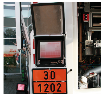
Highlight beim Willig-Aufbau: Steuerung per Touchpad im Heck.
