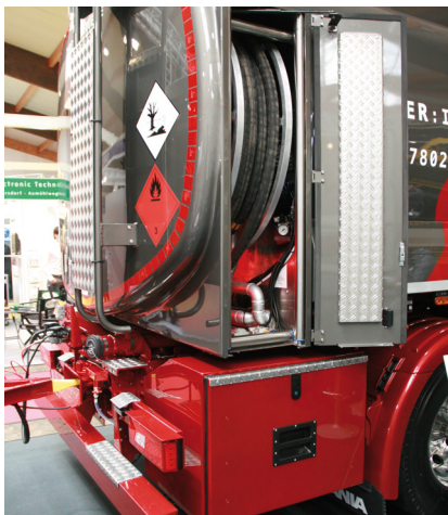
Von beiden Seiten zu bedienen: Die „Doppel-Trommel“ von Lindner & Fischer.
