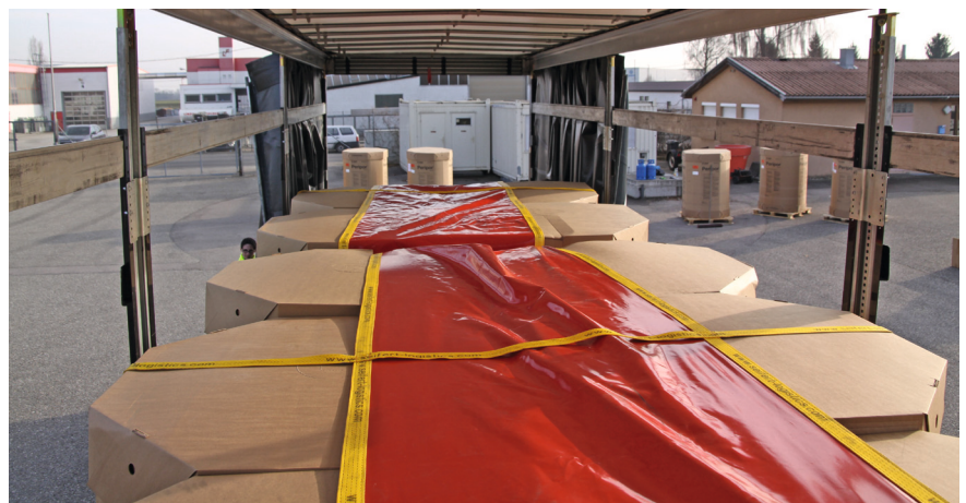
Sitzt die Plane erst einmal, liegt jeder Gurt automatisch am richtigen Platz.
