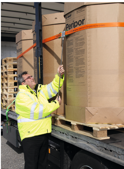
Wie sich Oktabins mit dem neuen System vom Boden aus sichern lassen, zeigt Sicherheitsbeauftragter Volker Pfeiffer.
