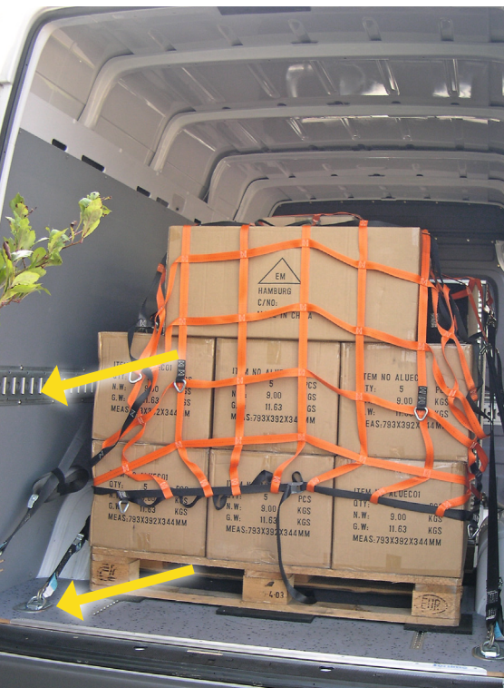
Hier kann sowohl kraft- als auch formschlüssig gesichert werden.
