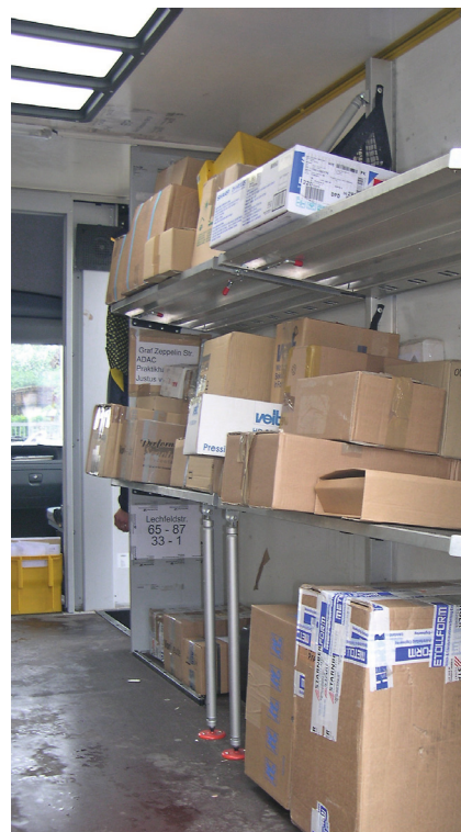
Die Neigung der Regalböden ist so gewählt, dass die Querkräfte kompensiert werden.
