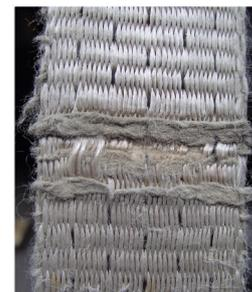
**Ende eines Gurts: Beschädigungen von mehr als 10% des Bandquerschnitts oder Verformung/Schädigung der Verbindungsmittel erfordern die bedingungslose Entsorgung.**
