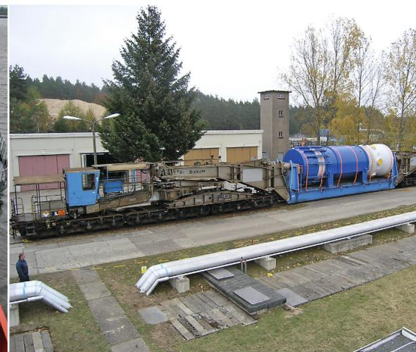
Beim Rückbau der Kernkraftwerke fallen große Mengen an „aktivierten“ Stahlkomponenten an, die oft in eine mehrere Jahrzehnte dauernde „Abklinglagerung“ gehen. Im Bild links Wärmetauscher des Kraftwerks Stade, rechts der Reaktordruckbehälter des Kraftwerks Rheinsberg.
