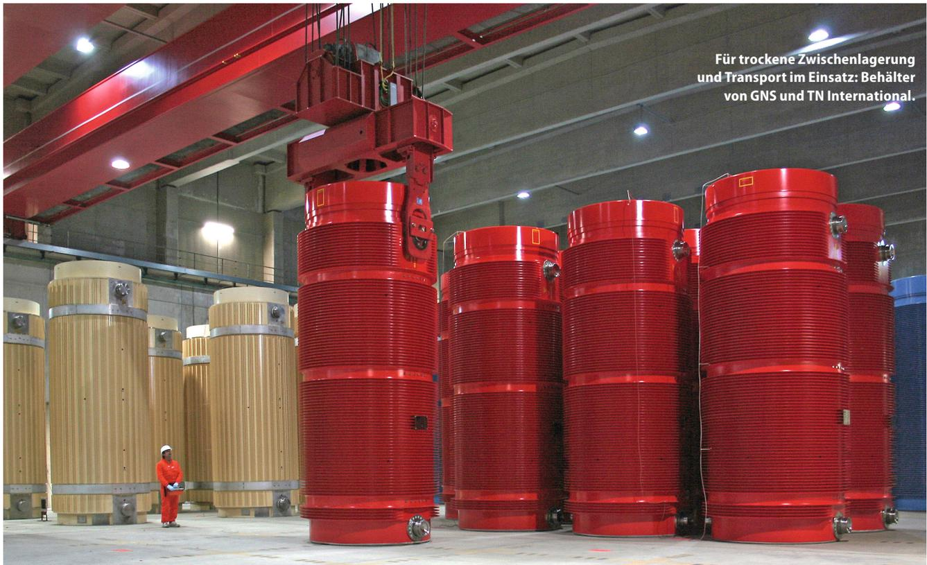
Für trockene Zwischenlagerung und Transport im Einsatz: Behälter von GNS und TN International.
