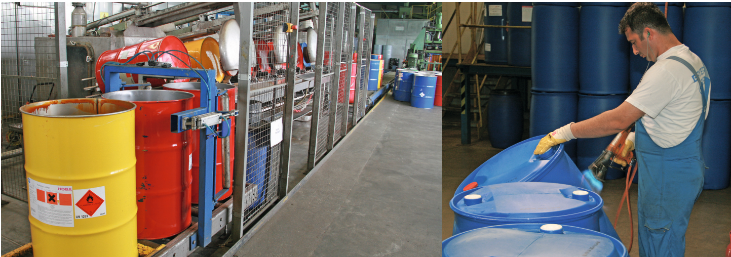
links: Entdeckelt kommen die Stahlfässer auf ein Förderband, das sie zur automatischen Innenreinigung mit Bürsten und Waschlaug führt. rechts: Kleinere Kratzer auf Kunststofffassern werden von Hand abgeflammt, um den Behälter wieder glatt und glänzend zu machen.
