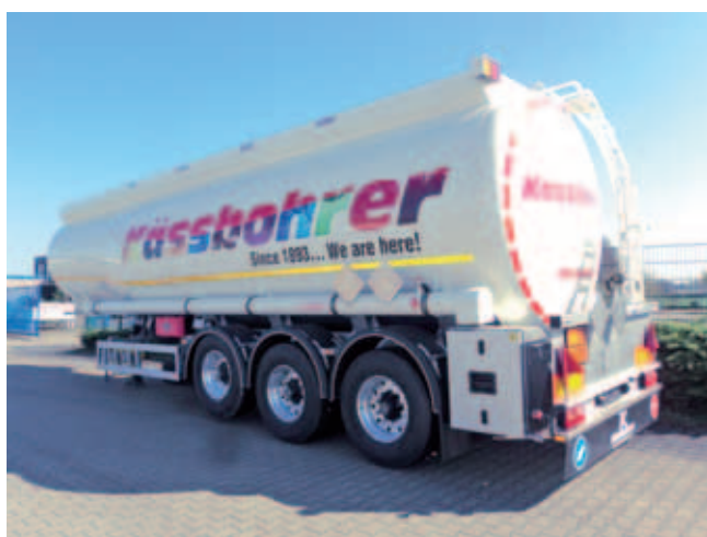
Tankaufleger für gefährliche Güter sind in Druckausführung und als drucklose Version lieferbar. | Tank trailers for dangerous goods are available in pressure and pressure-free versions.
