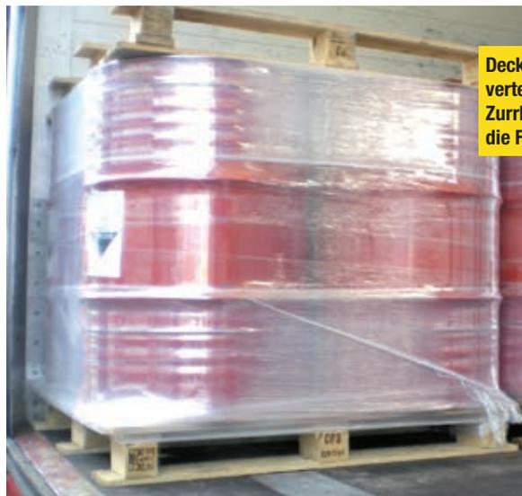
Deckpaletten verteilen die Zurrkraft auf die Fläche.
