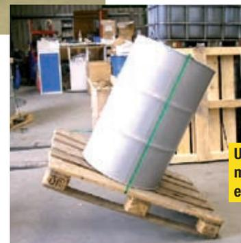
Umreifung mit Hilfe eines Bretts.
