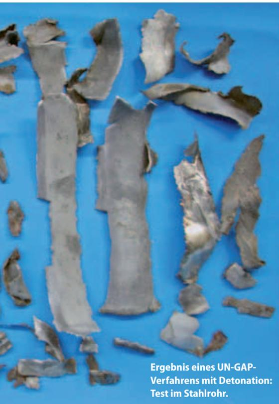
Ergebnis eines UN-GAP-Verfahrens mit Detonationstest im Stahlrohr.
