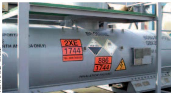
**Unvollständig gekennzeichneter Tankcontainer für Brom.**
