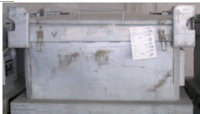
Für den Transport des Abfallprodukts UN 3190 sind zehn Kennzeich- nungen auf dem Metallcontainer anzubringen.
