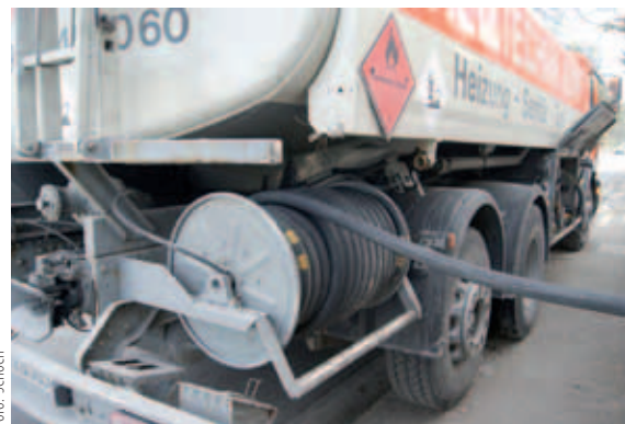
Betankungsschläuche müssen gegenüber Kraftstoffen, aber auch gegenüber mechanischen und klimatischen Einflüssen besonders robust sein
