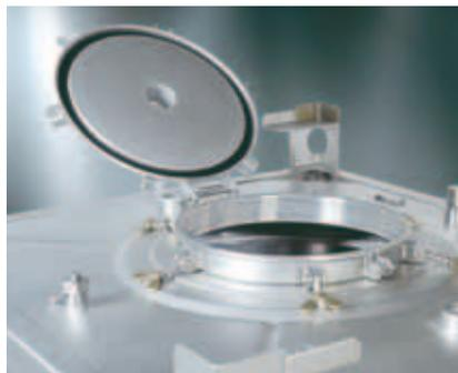
Neben Rührwerken, einer Füllstandsmessung und kundenspezifischen Anschlüssen können auch verschiedene Dichtungsqualitäten eingebaut werden.
