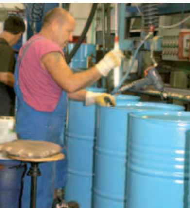
Letzte Prüfung vor der Freigabe der aufbereiteten Gebinde.
