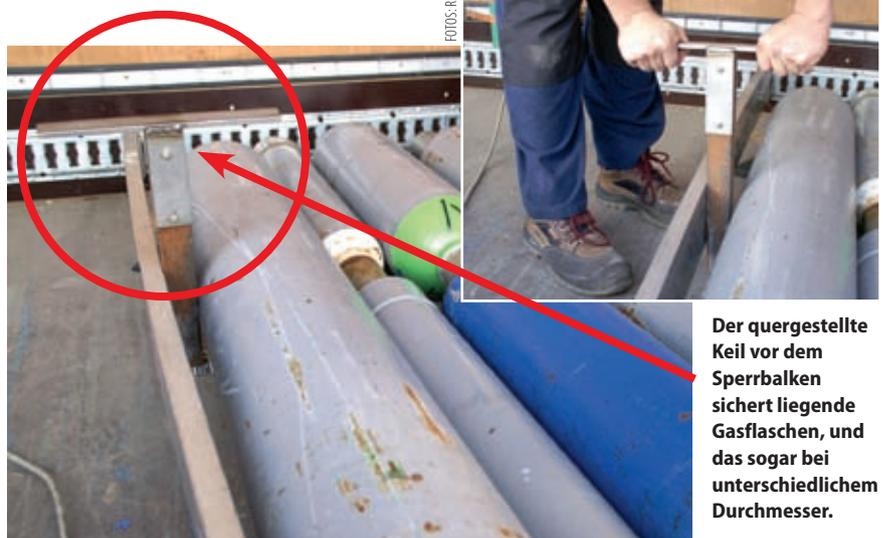
Der quergestellte Keil vor dem Sperrbalken sichert liegende Gasflaschen, und das sogar bei unterschiedlichem Durchmesser.
