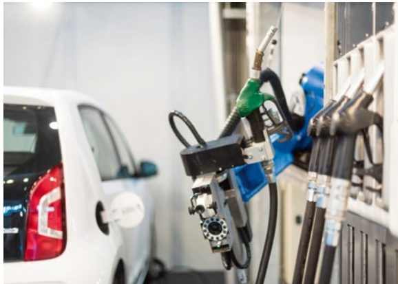
Der Tankroboter von Autofuel greift jede Zapfpistole aus der Reihe.
