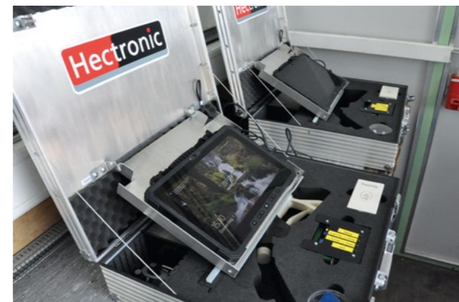
Analysewerkzeug im Koffer: Kommt es zu Problemen bei der Erkennung von Fahrzeugen, kann ein Techniker vor Ort hiermit den Fehler auslesen.
