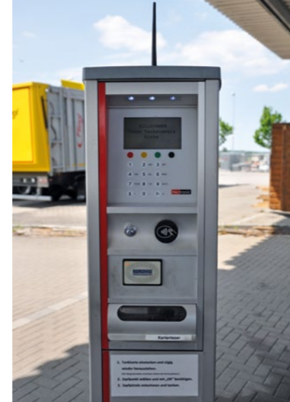
Die Antenne des Tankautomaten kommuniziert mit einem im Fahrzeug verbauten Empfänger. So werden Kilometerstände übertragen.
