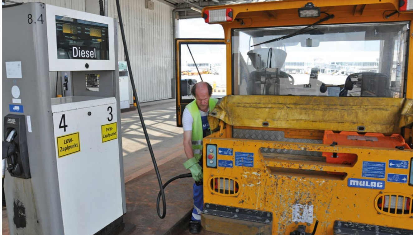
Fahrzeuge der Flughafenflotte, wie dieser Kofferschlepper, werden vor der Freischaltung der Zapfsäule per Tag identifiziert und autorisiert.
