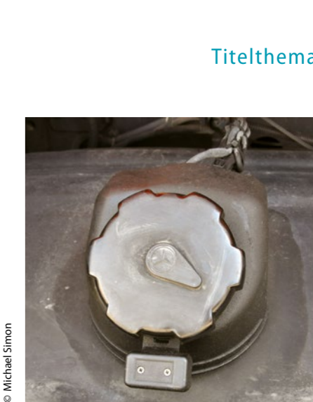
Wird der Tag (unterhalb der Tanköffnung) vom Stationsempfänger erkannt, erhält der Automat eine Autorisierung und gibt die Pumpe frei.
