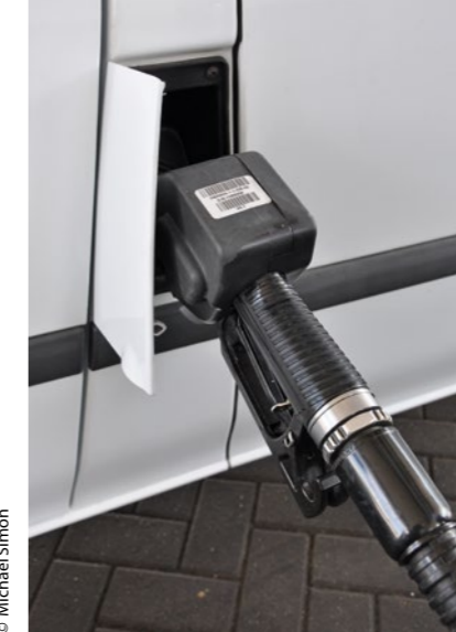
Für die Freischaltung der Zapfsäule findet eine zweite Unterhaltung statt: Die Nozzle-Einheit an der Pistole scannt einen Tag am Fahrzeug.
