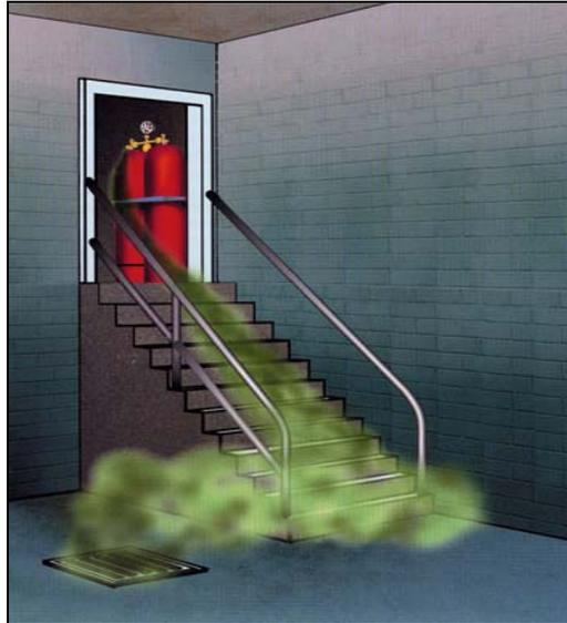
**Abb. 2.3:** Ausbreitungsverhalten von verflüssigten Gasen (Beispiel)<sup>4</sup>.
