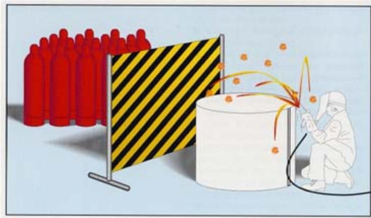
**Abb. 4.2:** Beispiel für Abschirmmaßnahmen bei Arbeiten mit Funkenflug<sup>4</sup>.
