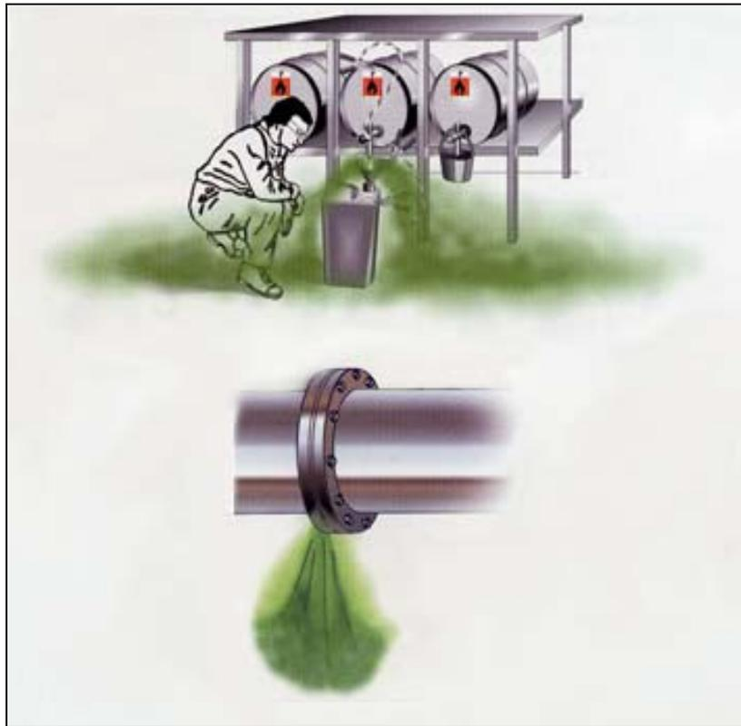
**Abb. 1:** Beispiele für die Entstehung explosionsfähiger Atmosphäre<sup>4</sup>.
