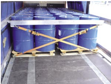
Sperrbalken mit Diagonalzurrung
