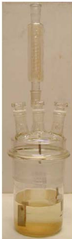
Abbildung 37.4.2: AUSLAGERUNGSGEFÄSS MIT RÜCKFLUSSKÜHLER
