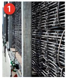
Lasi-Hilfe: Auf einem speziellen Fahrzeug können Betonstahlmatten in alle Richtungen formschlüssig z. B. durch Steckrungen gesichert werden.
