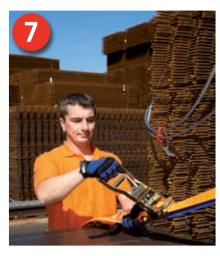
Die hier orangeabgebildeten Gurte werden quer an Zurrpunkten befestigt und handfest vorgespannt. Sie sichern gegen seitliches Verrutschen.
