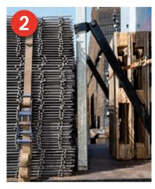
Zusatzstütze: In Fahrtrichtung sind die Steckrungen wegen der höheren Belastung zusätzlich nach vorne abgestützt.
