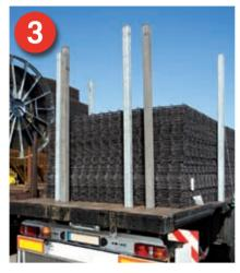
Formschluss: Auch nach hinten und zur Seite liegen die Betonstahlmatten formschlüssig an den Steckrungen an.
