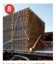
An jeder Stapelecke kommt ein DoUniFlex zum Einsatz. Damit ist der Stapel Betonstahlmatten in alle Richtungen ausreichend gesichert.
