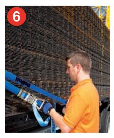
Die blau abgebildeten Gurte werden seitlich an Zurrpunkten befestigt und handfest vorgespannt. Sie sichern gegen Verrutschen in Fahrtrichtung.
