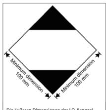
Die äußeren Dimensionen des LQ-Kennzeichens werden mit Einführung des ADR 2015 exakt vorgegeben mit 10 mal 10 cm.
