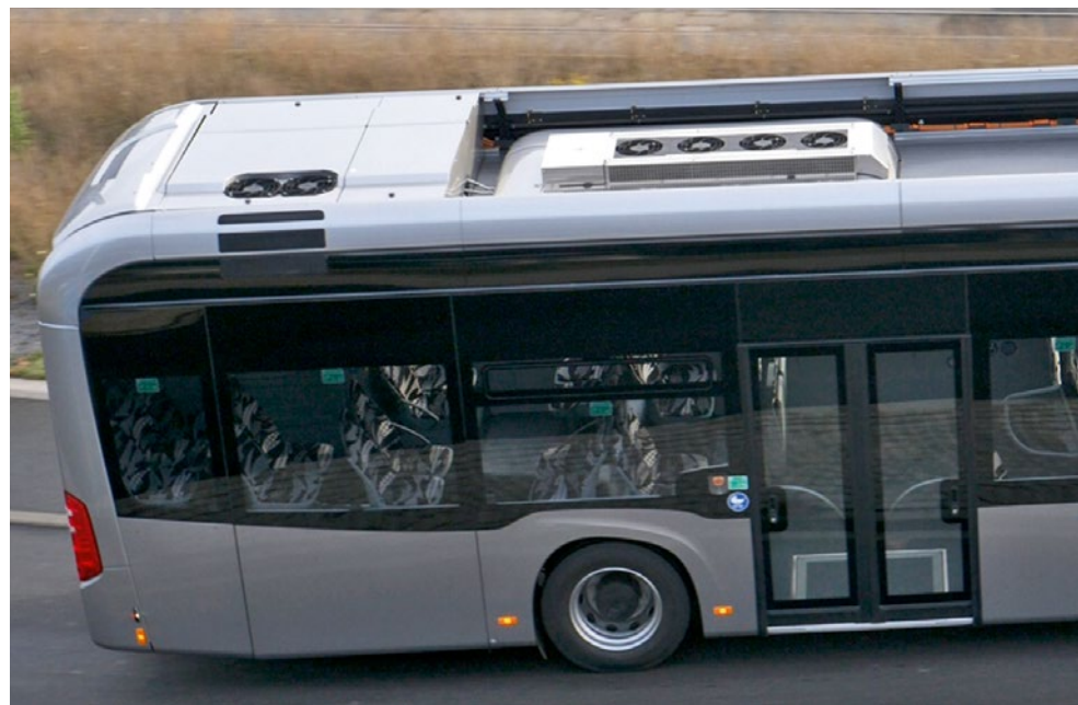
Die drei Fotos hier zeigen die Einbauorte der Akasol-Batteriesysteme beim eCitaro. Sie befinden sich standardmäßig im Heck und bei Bedarf auf dem Dach im vorderen Bereich. Gut zu erkennen ist die Anbindung des Kühlsystems
