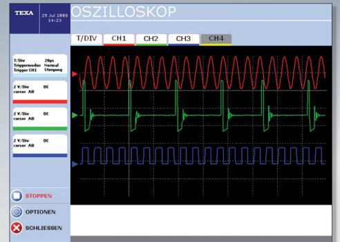
IDC3 Einbindung und PC-Anbindung, 4 - Kanal Oszilloscope.
