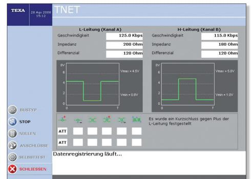
TNET-Modul zur Prüfung der CAN-Bus Datenleitungen.
