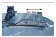
Durch die verschiebbaren Spannklauen können Räder von 12" bis 26" (optional bis 30") bearbeitet werden.
