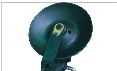
Der Abdrückteller ist mit einem speziellen patentierten Kippsystem ausgestattet, um einmal die Abdrückkraft zu erhöhen und zum anderen sicherzustellen, dass der Teller immer in optimaler Position zur Felge steht.
