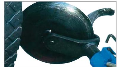
Der Abdrückteller ist mit einem speziellen Kippsystem ausgestattet, um einmal die Abdrückkraft zu erhöhen und zum anderen sicherzustellen, dass der Teller immer in optimaler Position zur Felge steht.
