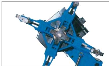
Das Spannfutter ist in Massivbauweise hergestellt, um die Bearbeitung von Rädern bis 1500 kg sicherzustellen. Ein Rückschlagventil verhindert ein Öffnen des Spannfutters im Falle eines plötzlichen Hydraulikdruckabfalls.
