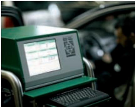
Neben der gesetzlichen AU bietet Ihnen der GM3 die perfekte Ergänzung für Ihre Diagnosearbeiten. Die Messung von CO, HC oder CO<sub>2</sub> erfolgt in Sekundenschnelle und hilft zuverlässig bei der Ermittlung von Motor- und Verbrennungsproblemen. Die optimale Kombination von Abgastester und Multimarkeendiagnose in einem Gerät steckt im tausendfach bewährten compaa macs.
