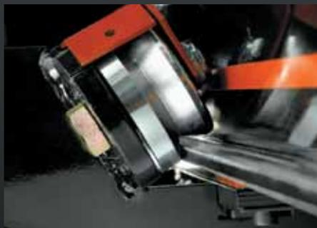
Die Rollenlager werden im Kanal angehoben, wenn der Richtturm arretiert ist und sind während des Ziehens unbelastet, für einen jahrelangen wartungsfreien Betrieb.
