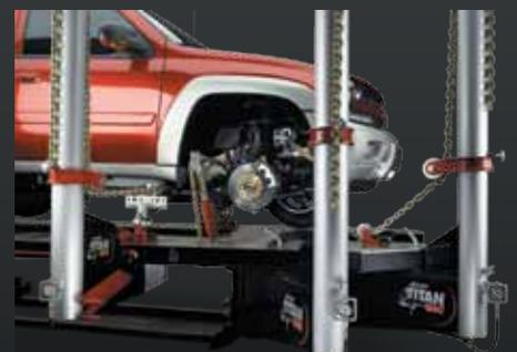
Das einzigartige Design der Titan ermöglicht die Zusammenfassung von drei Richttürmen für schnellere und genauere Reparaturen.
