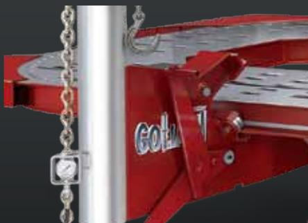
Der patentierte Sure-Lock® Mechanismus hält die Richttürme wie eine riesige Greifzange.
