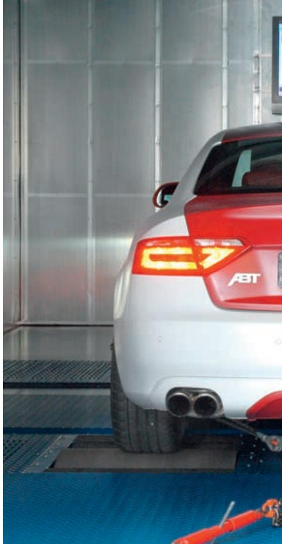
PS und Drehmomente weit über 1000 Nm können damit problemlos gemessen werden. Mit dem Scheitelrollen-Prinzip des MAHA MSR Leistungsprüfstands wird die Kraft selbst extrem leistungsstarker Fahrzeuge ohne Schlupfprobleme auf die Rolle übertragen. Prüfungsgeschwindigkeiten über 300 km/h sind möglich.
