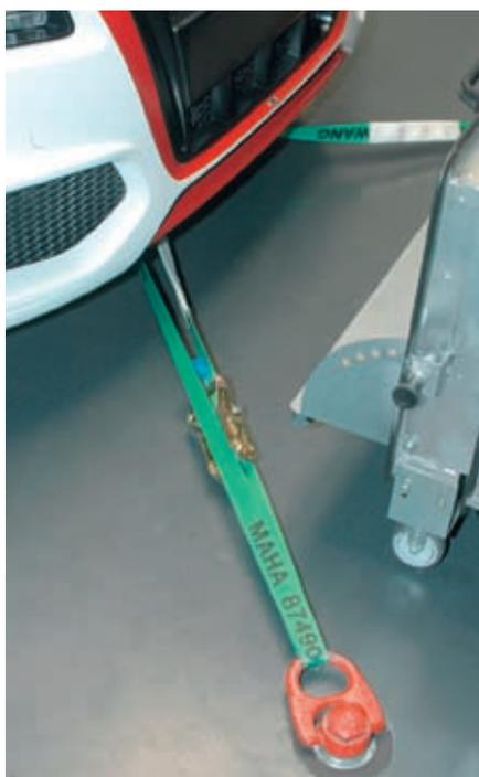
Damit das Fahrzeug sicher auf dem Prüfstand hält, wird es vor jedem Einsatz fest verspannt
