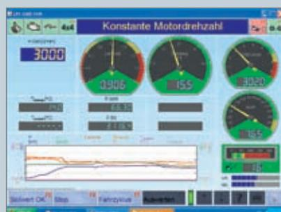
In diesem Prüfprogramm werden bei konstanter Motordrehzahl Lastzustände simuliert
