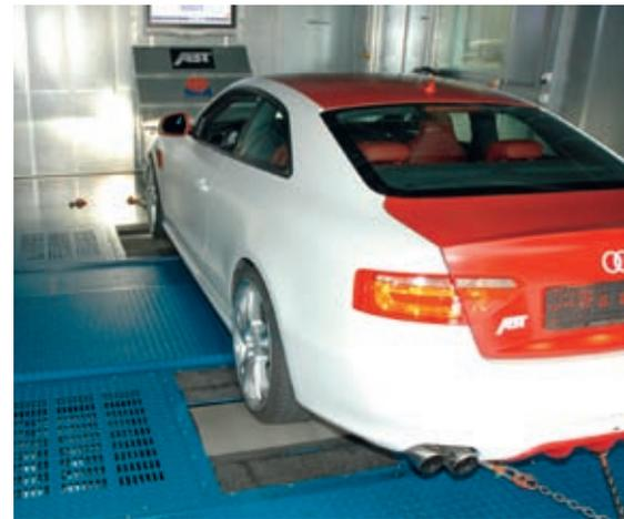
Während der Prüfung rollen die Räder auf dem Scheitelpunkt der Prüfrollen ab
