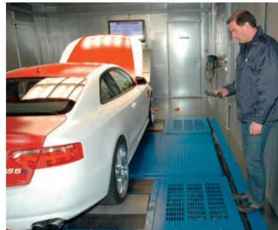
Der Abstand der Rollensätze wird genau auf den Radstand des Fahrzeugs eingestellt
