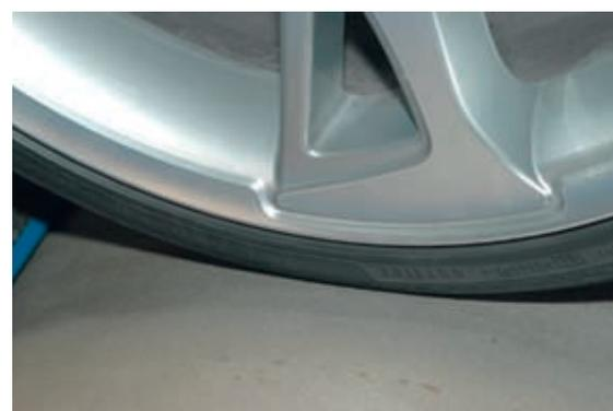
Großer Vorteil der Scheitelrolle ist die geringe Belastung des Reifens während des Prüflaufs
