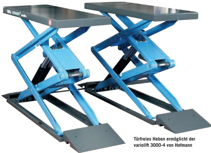
Türfreies Heben ermöglicht der variolift 3000-4 von Hofmann
