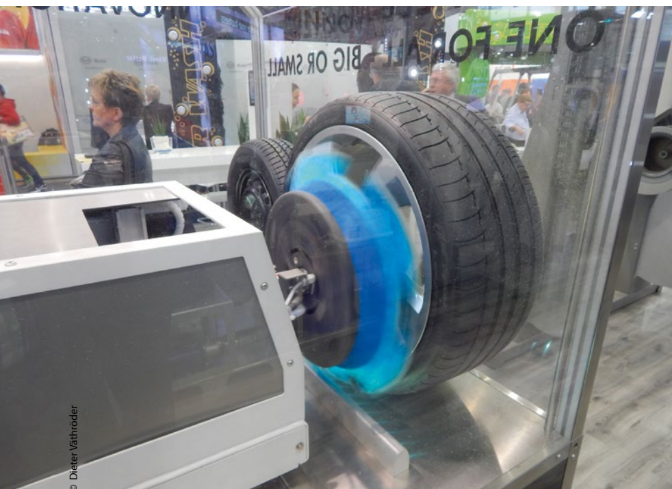
Räder werden immer größer, aber auch kleine Felgen müssen mittig getroffen werden. Sensoren messen beim Wheel Master 4D das Rad ein. Längs- und Höhenverstellung für große Räder.
