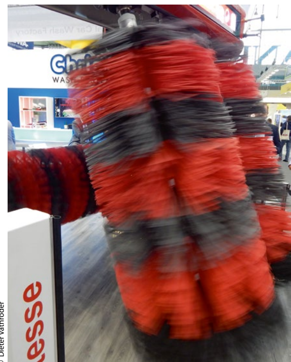
Modische Schräghecks mit Dachspoiler: Maxi Flex+ passt sich bis 25 Grad Neigung an.
